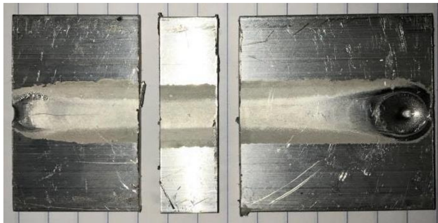
Figura 10 – Corpo de prova após o corte.
