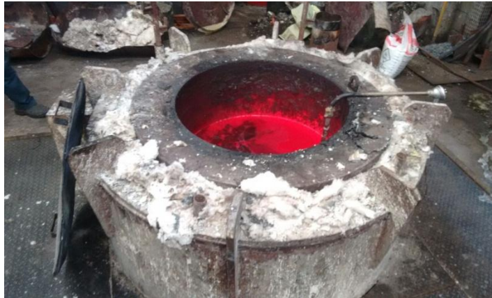
Figura 17 - Forno para processamento em banho de sal.
