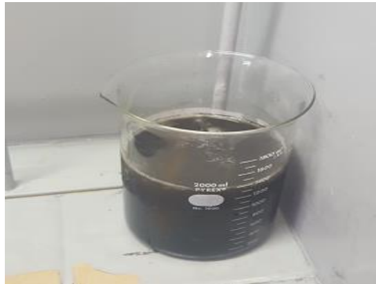
Figura 7 - Solução de Oxido de Grafite esfoliado em peróxido de hidrogênio
