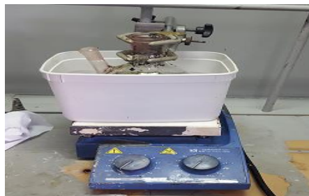
Figura 5 - Solução de óxido de Grafite e H_2SO_4 e KMnO_4 em agitação.
