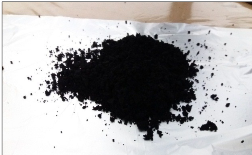
Figura 18: Nanotubo de Carbono antes de passar por etapa de secagem.
