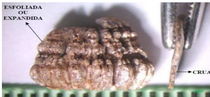
Figura 3 – Comparação de volume entre a vermiculita crua e expandida
