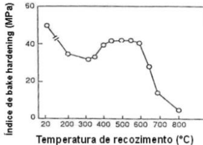
Figura 6-Efeito da temperatura de recozimento de uma chapa no índice bake hardening
