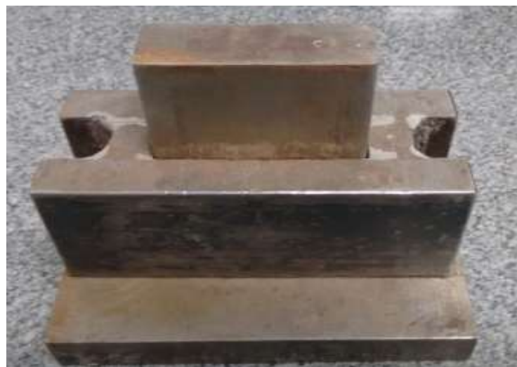
Figura 8 - Molde utilizado para confecção dos corpos de prova.
