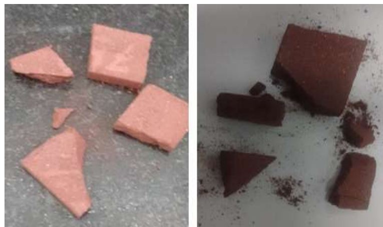
Figura 15 - Corpos de prova que sofreram fratura prévia após a sinterização, com composição de 75% e 100% de rejeito, respectivamente.
