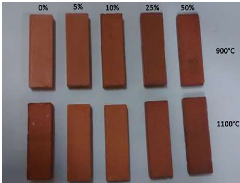
Figura 14 - Corpos de prova de argila Terracota com rejeito com as proporções indicada na figura, após sinterização.
