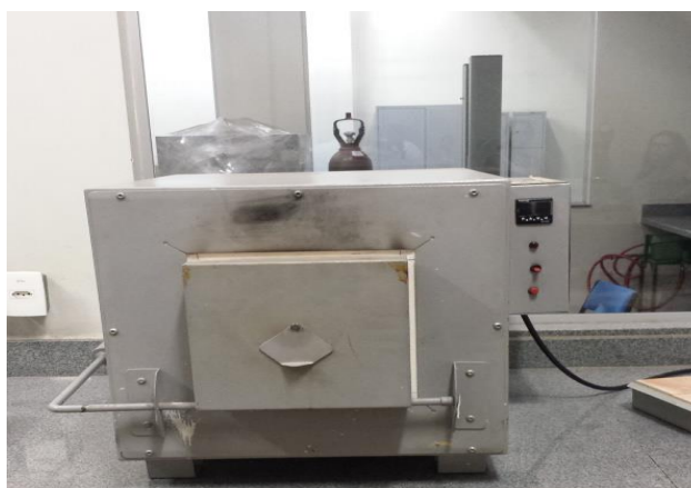
Figura 21 – Forno elétrico utilizado para realização dos tratamentos térmicos.
