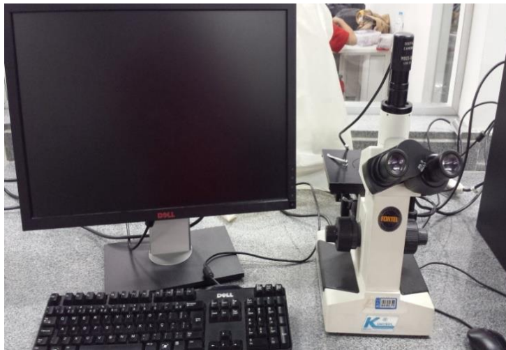
Figura 24 – Microscópio óptico marca Fortel utilizado na análise da microestrutura.
