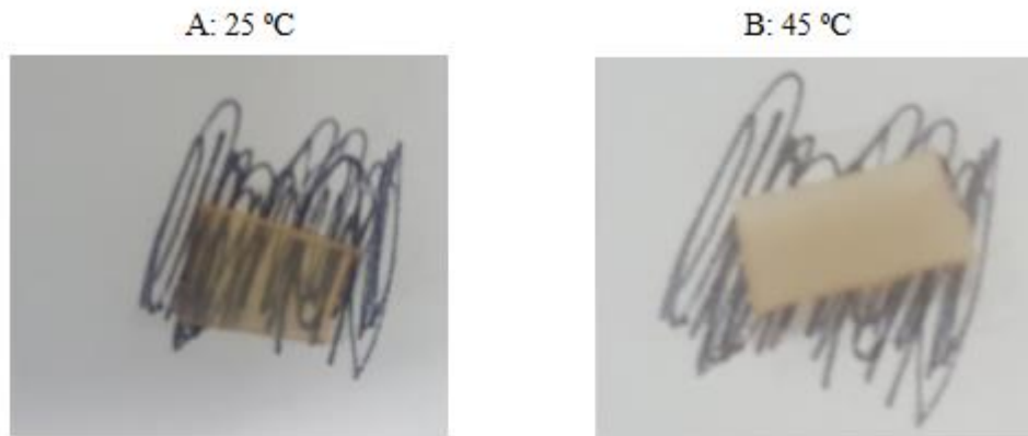
Figura 34) Alterações visíveis no filme de poliuretano tratado por 2 horas com UV e submetido à reação de grafitação isoladamente. Painel A, filme a 25°C e Painel B, filme a 45°C.
