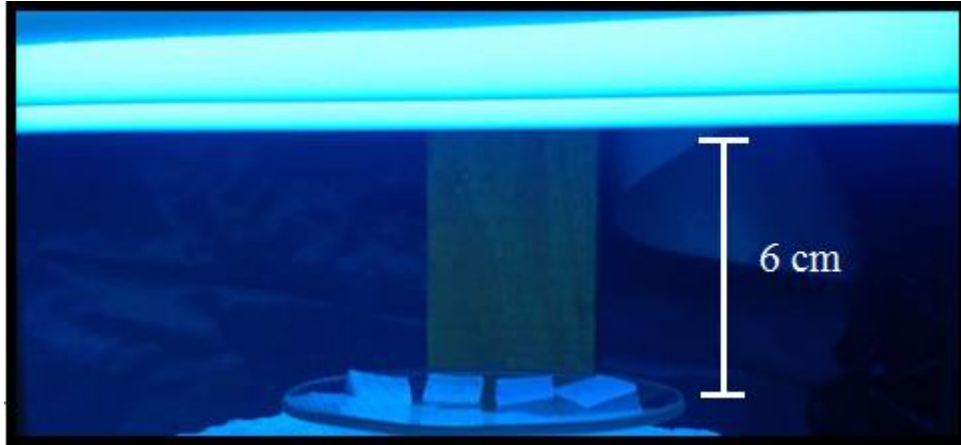
Figura 17) Aparato para tratamento superficial dos filmes de poliuretano por radiação ultravioleta (UV).
