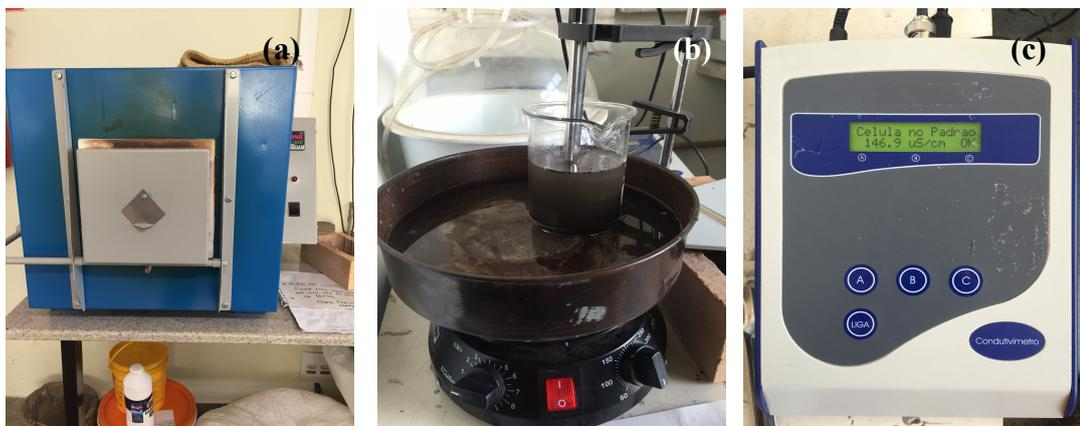
Mufla (a); Montagem do experimento (b); Condutivímetro Tecnocon, mCA150 (c). Fonte: Própria.
