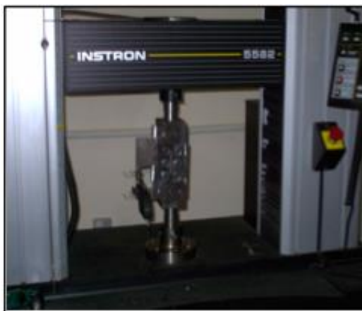
Figura 4.2 - Dispositivo para ensaio de cisalhamento acoplado à máquina de ensaios universais Instron 5582.
