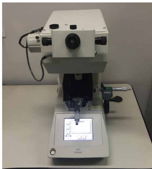
Figura 4.5 - Microdurômetro Shimadzu ® HMV.
