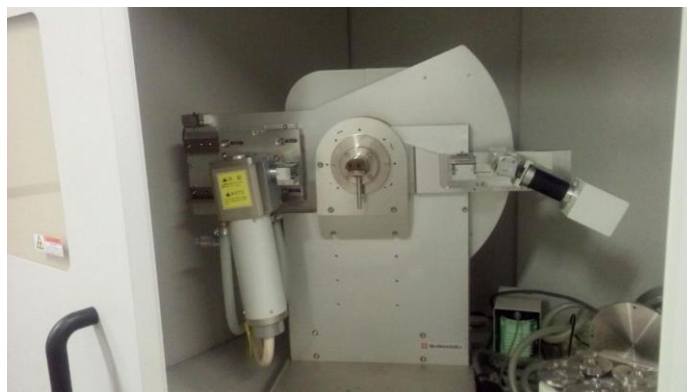
Figura 4.4 - Difratorômetro Shimadzu® XDR – 7000.
