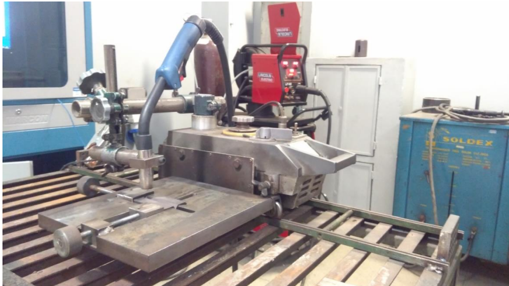
Figura 28 – Processo de soldagem automatizado
