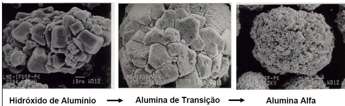
Figura 4 - Imagem mostrando a evolução do processo de calcinação.
