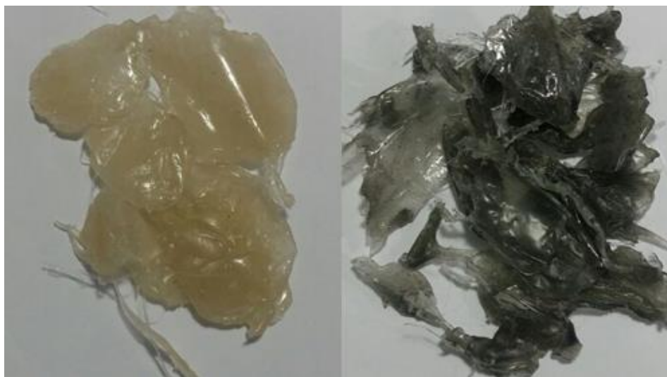
Figura 23 - PP puro à esquerda e compósito à direita, processados no Haake
