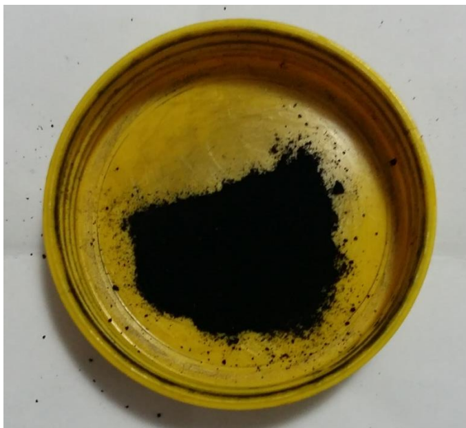
Figura 20 - Nanotubo de Carbono de paredes múltiplas, funcionalizado por meio da rota ácida de \text{HNO}_3/\text{H}_2\text{SO}_4 .
