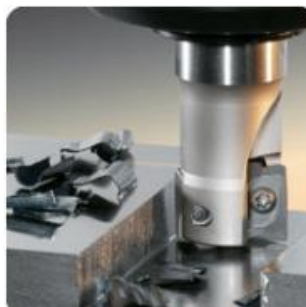
Figura 3 - exemplificação do fresamento de topo
