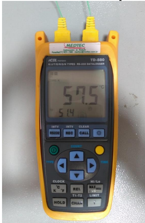
Figura 9 - Termômetro com dois termopares conectados
