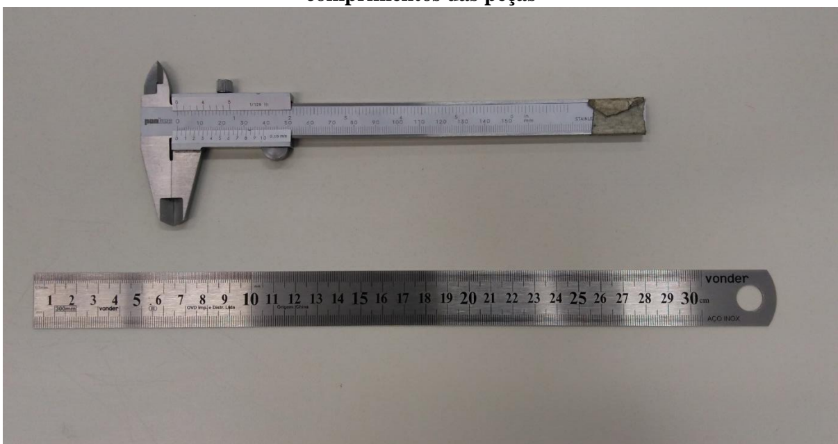
Figura 7 – Paquímetro e escala utilizados na medição dos diâmetros e dos comprimentos das peças
