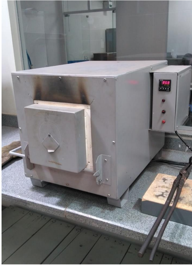
Figura 8 - Forno utilizado no tratamento térmico das peças
