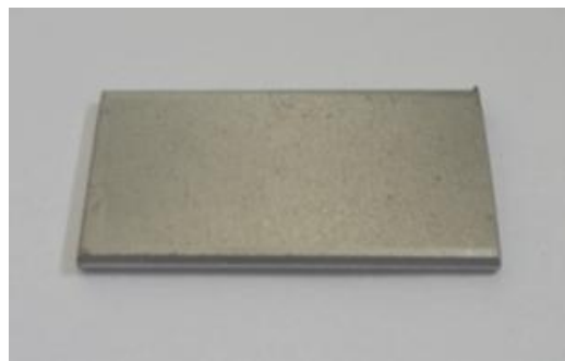
Figura 22– Corpo de prova para caracterização (microestrutura e dureza) no estado inicial e após tratamentos térmicos
