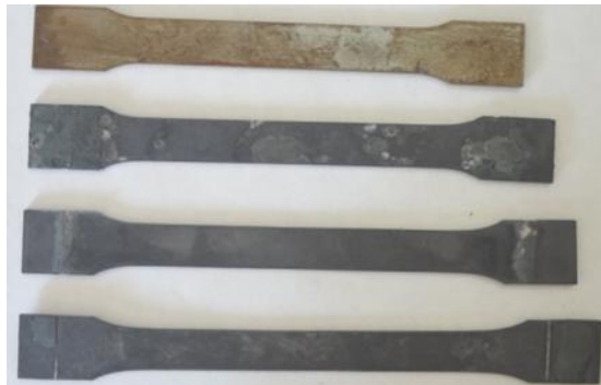
Figura 36– Corpos de prova apenas normalizados, normalizados e pré-deformados de 10%, 20% e 30%
