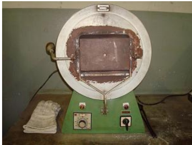
Figura 171: Forno utilizado nos tratamentos térmicos
