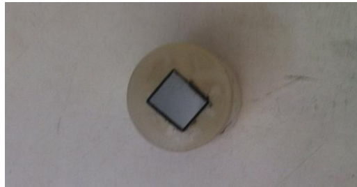
Figura 19: Corpo de prova utilizado para a realização da análise microestrutural e dos ensaios de dureza.
