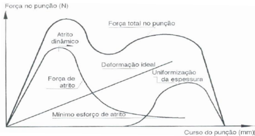
Figura 135: Esforços atuantes no processo de Estampagem
