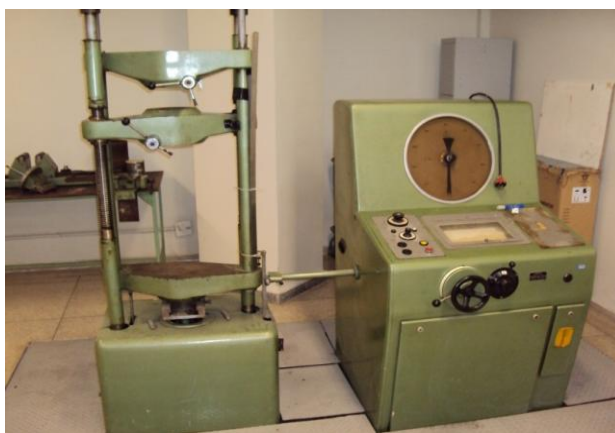
Figura 33 – Máquina de Ensaio de Tração Universal Modelo WPM - ZD 20
