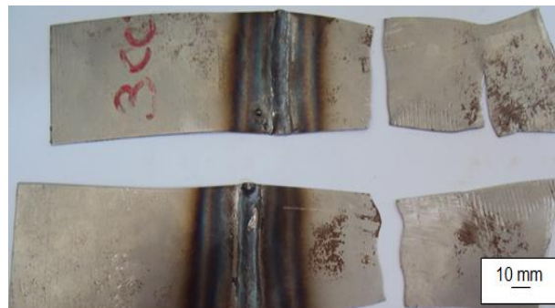
Figura 45 – Corpos de Prova após o Teste de Tração de Juntas Soldadas pelo Procedimentos 1
