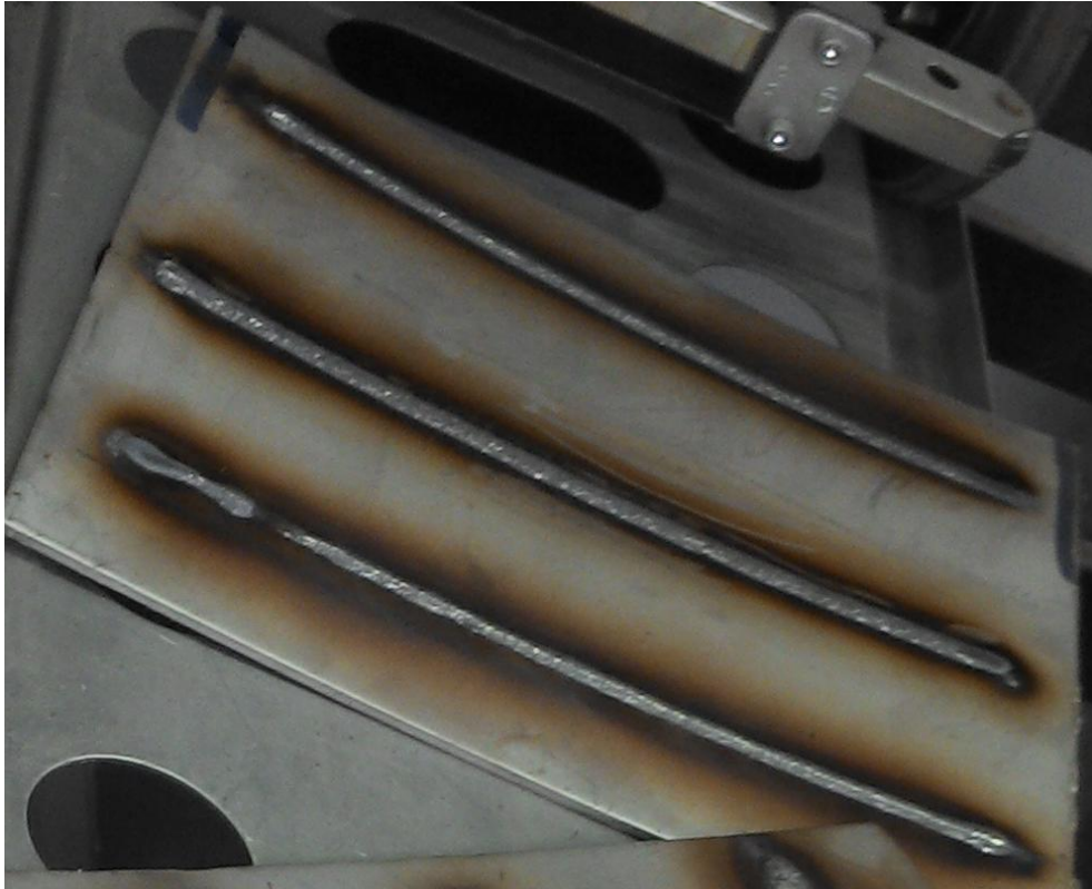
Figura 11 - Chapa de aço inoxidável AISI 304 soldada com aporte térmico de 1,0 kJ/mm.
