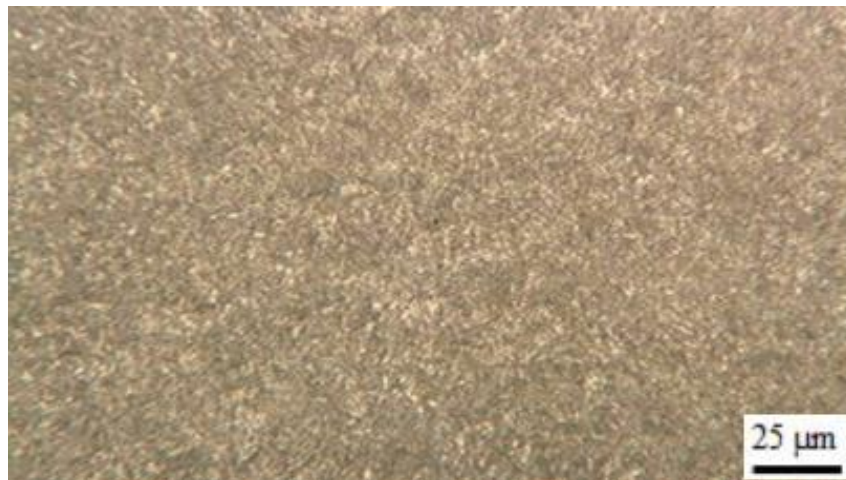
Figura 27 - Micrografia corpo de prova resfriado em óleo e revenido em 400°C
