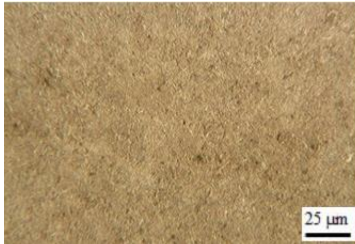
Figura 28 - Micrografia corpo de prova resfriado em água e revenido em 350°C
