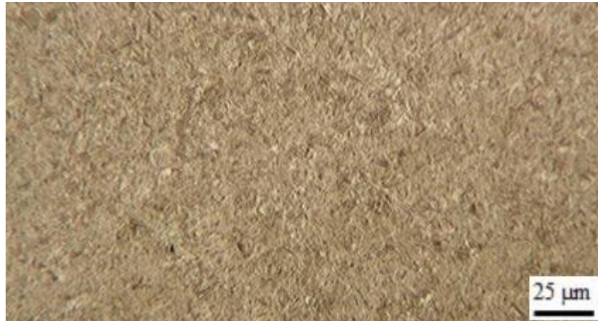
Figura 26 - Micrografia corpo de prova temperado
