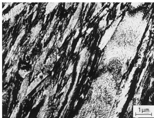
Figura 3-9 – Microestrutura da martensita em ripa em um aço 4140 revenido a 150°C (MET).
