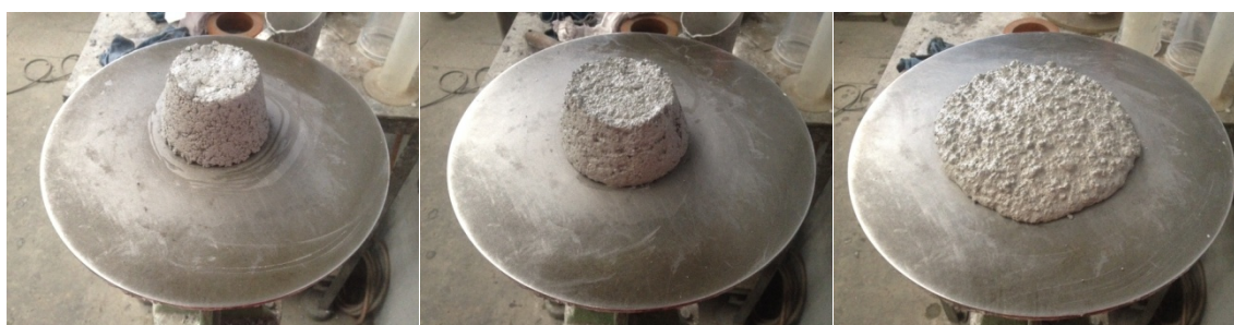
Figura 14 – Comportamento reológico do sistema SC: a) Socado: 4,9%- peso de água; b) Vibrado: 5,5%- peso de água; c) Fluência Livre: 6,3%- peso de água.
