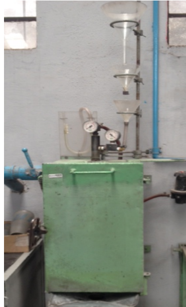
Figura 10 - Erosímetro para refratários.
