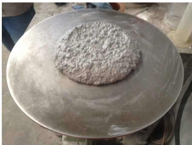
Figura 15 – Fluência após 15 batidas do sistema CAC: 51%
