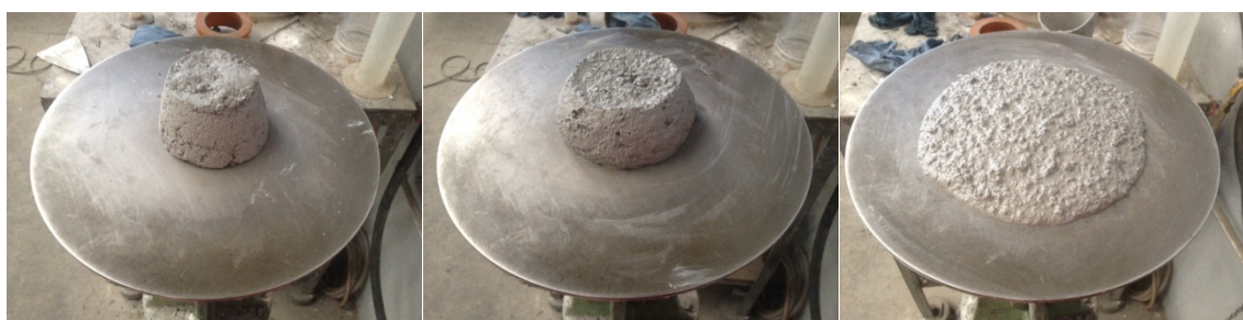
Figura 13 – Comportamento reológico do sistema CAC: a) Socado: 5,7%- peso de água; b) Vibrado: 5,8%- peso de água; c) Fluência Livre: 6,3%- peso de água.
