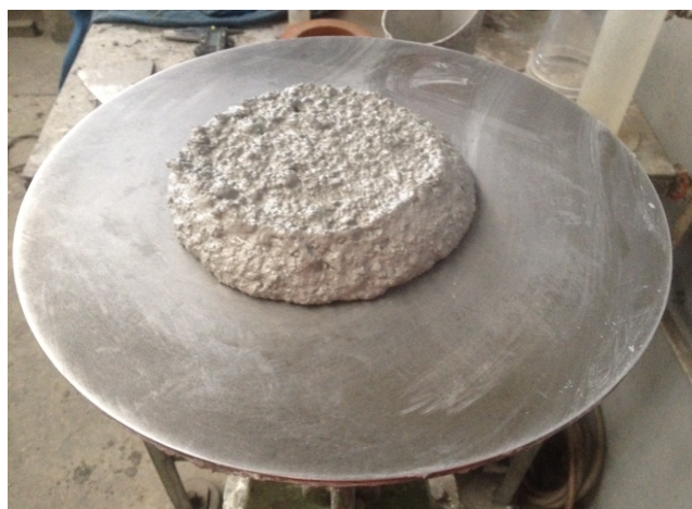
Figura 16 – Fluência após 15 batidas do sistema SC: 44%
