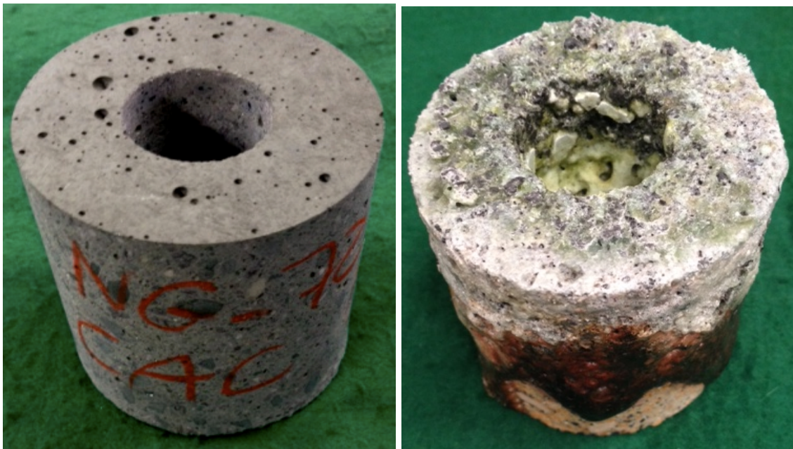
Figura 26– Corpos de prova do sistema CAC antes (a) e após (b) teste de resistência ao ataque por álcalis
