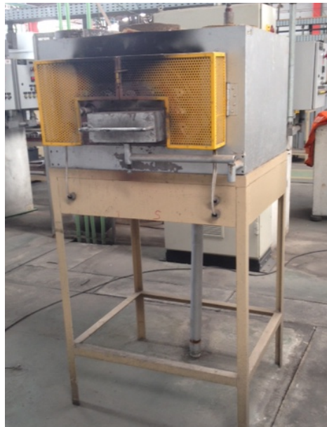
Figura 11 - Forno utilizado para o teste de resistência a choque térmico.
