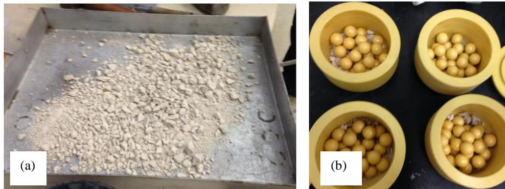
(a) Aspecto das amostras após quebra. (b) Material quebrado em moinho de bolas com esferas de óxido de zircônia.
