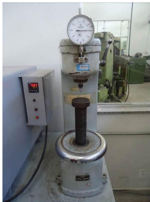
Figura 14 – Durômetro IGV ® modelo RM 401/A usado no teste de dureza
