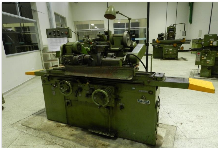
Figura 8 - Retificadora cilíndrica universal utilizada nos experimentos.
