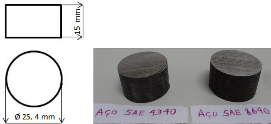
(a) Desenho com as dimensões das amostras, (b) Amostras após cortadas e retificadas
