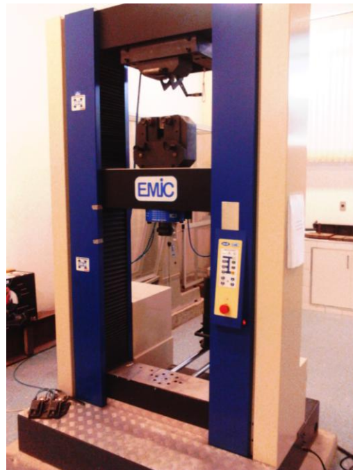
Figura 21 – Máquina para ensaios de tração EMIC ® DL30000N .
