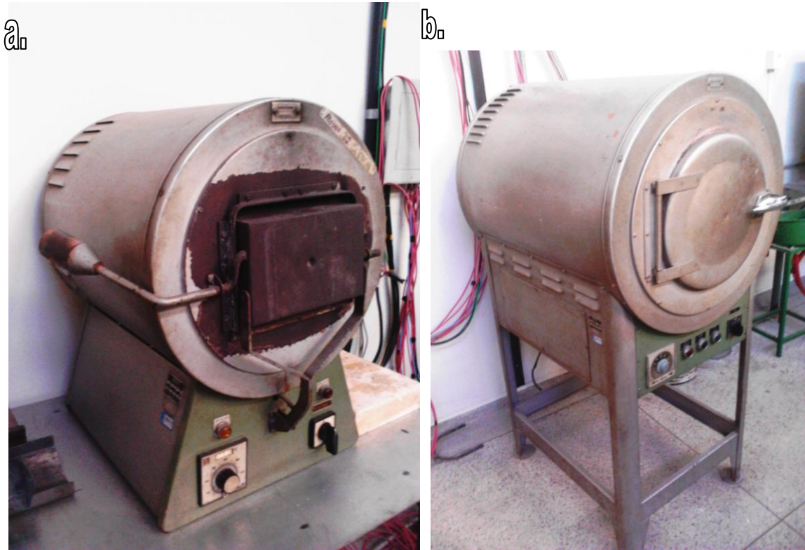
a) Forno utilizado para austenitização e têmpera seguida de revenimento; b) forno empregado para o resfriamento isotérmico.
