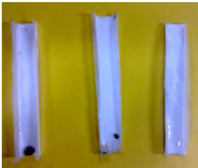
Figura 4.3- Amostras de PVA/HA 70/30 após secagem
