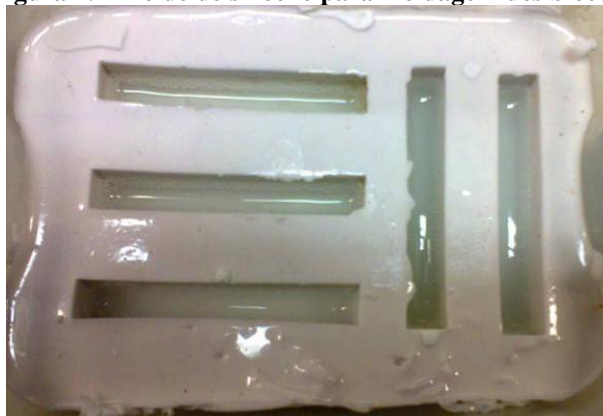
Figura 4.2-Molde de silicone para moldagem dos blocos
