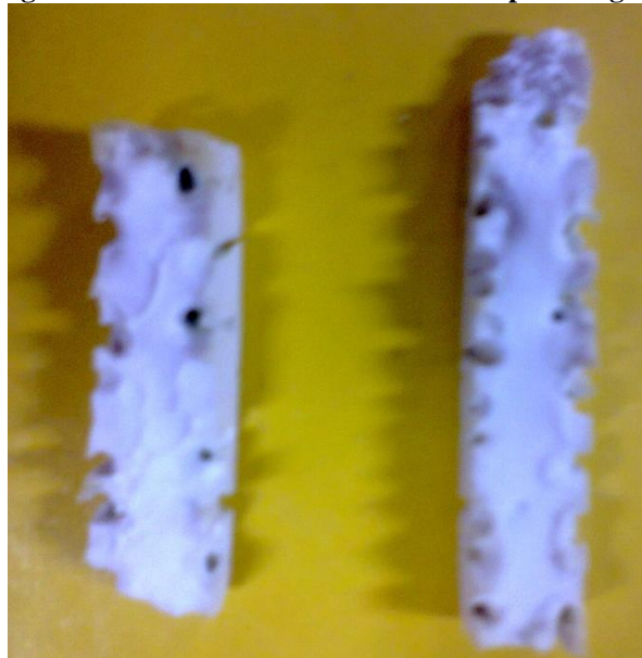
Figura 4.4- Amostras de PVA/HA 30/70 após secagem
