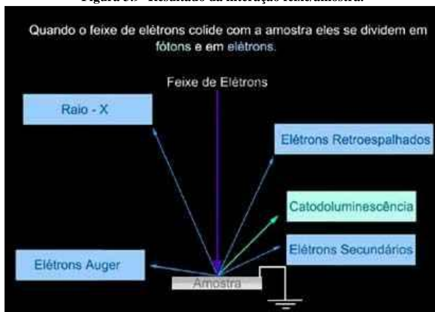
Figura 3.9- Resultado da interação feixe/amostra.
