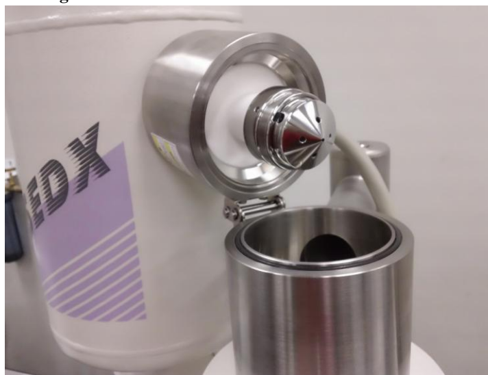
Figura 3.10 - Canhão de elétrons do MEV Shimadzu.
