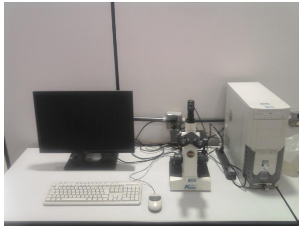
Figura 11 - Microscópio óptico utilizado para análise da microestrutura
