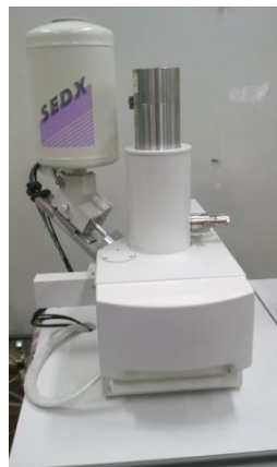
Figura 12 - Microscópio eletrônico de varredura empregado para análise da microestrutura
