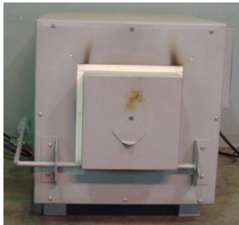
Figura 10 - Forno elétrico empregado nos tratamentos térmicos
