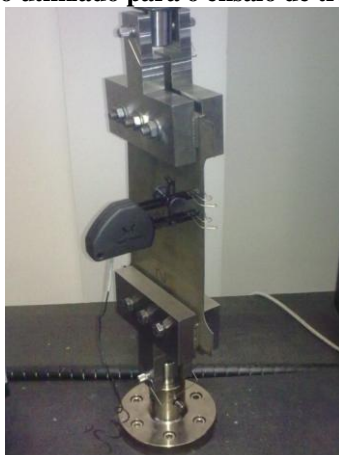
Figura 4.3 - Dispositivo utilizado para o ensaio de tração em chapas largas.
