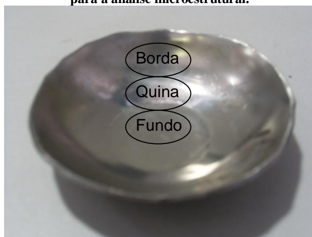
Figura 4.13 - Corpo de prova estampado com a identificação das regiões que foram retiradas amostras para a análise microestrutural.
