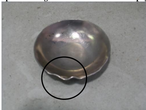
Figura 3.14 - Exemplo de enrugamento formado na estampagem de uma chapa.
