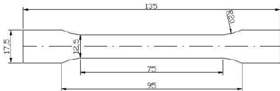
Figura 4.1 - Desenho do corpo de prova de tração utilizado nos ensaios para a caracterização mecânica do aço AISI 430, medidas em milímetros.
