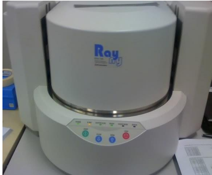
Figura 4.12- Espectrômetro RayNy EDX-720 Shimadzu do laboratório de caracterização de materiais do departamento de Engenharia de Materiais CEFET-MG.
