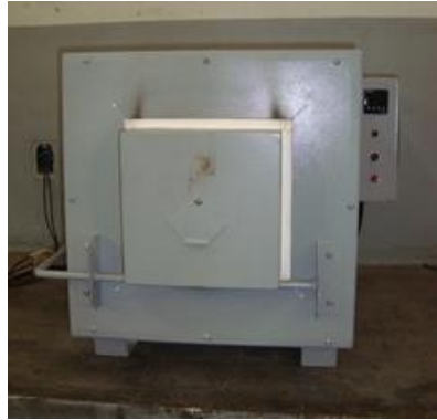
Figura 4.17- Forno Novus N1040 do laboratório de tratamento térmico do CEFET-MG.
