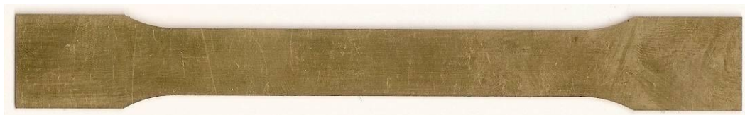
Figura 4.1- Corpo de prova para tração do latão no estado como recebido.
