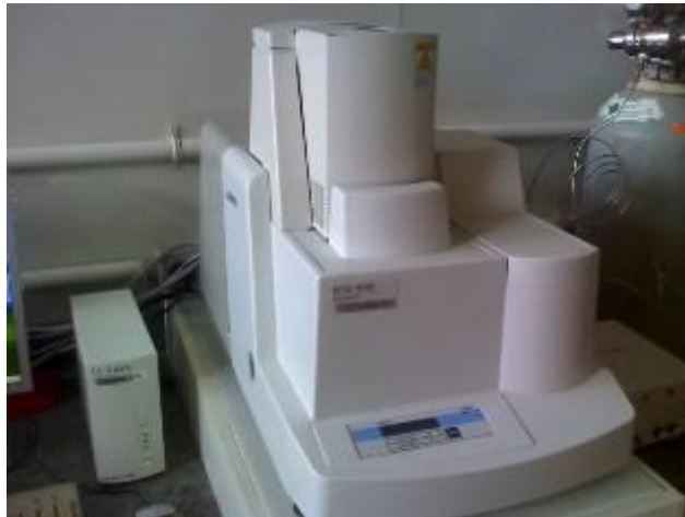
Figura 4.13- Equipamento usado para a análise térmica das amostras do latão CuZn34, Simultaneous DTA-TG Aparatus , Shimadzu, do laboratório de caracterização de materiais do departamento de Química Tecnológica do CEFET-MG.
