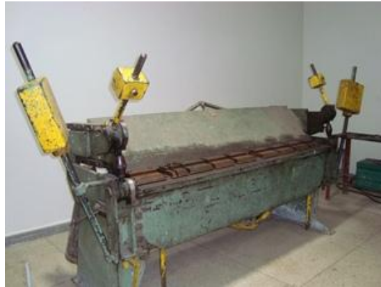
Figura 4.14- Dobradeira mecânica do laboratório de Calderaria do CEFET-MG.
