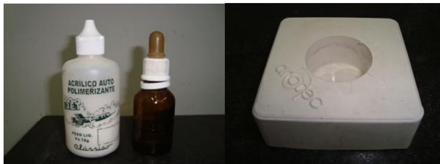
Figura 4.5- Material empregado para o embutimento. (a) Acrílico auto-polimerizante no estado sólido e líquido, respectivamente e (b) Molde de silicone.
