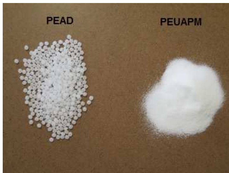
Figura 7 -Polímeros virgens. À esquerda, PEAD e à direita, PEUAPM.
