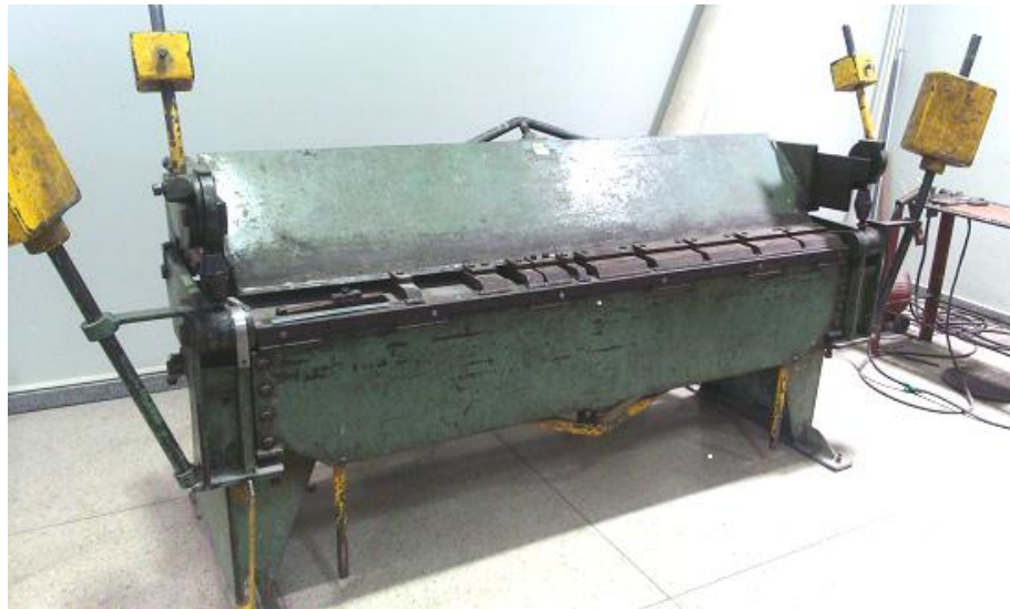
Figura 19 – Prensa viradeira usada na dobragem das chapas
