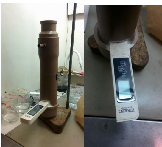
Figura 31 – Célula de filtração construída
