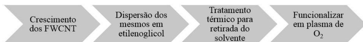
Figura 13 – Fluxograma do processo de fabricação da rede de nanotubos
