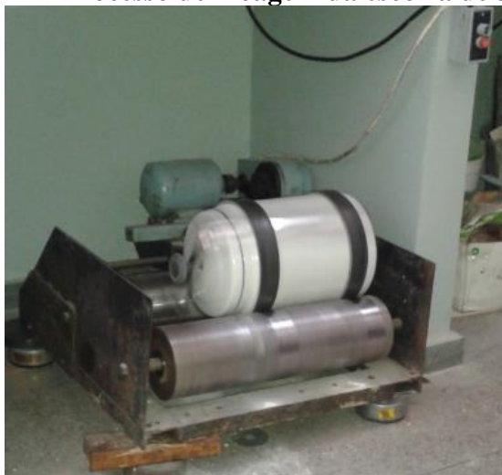
FIGURA 4 - Processo de moagem da escória de alumínio.
