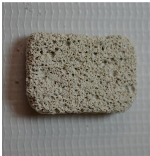
Figura 1 – Detalhe para a distribuição dos poros no concreto celular autoclavado.
