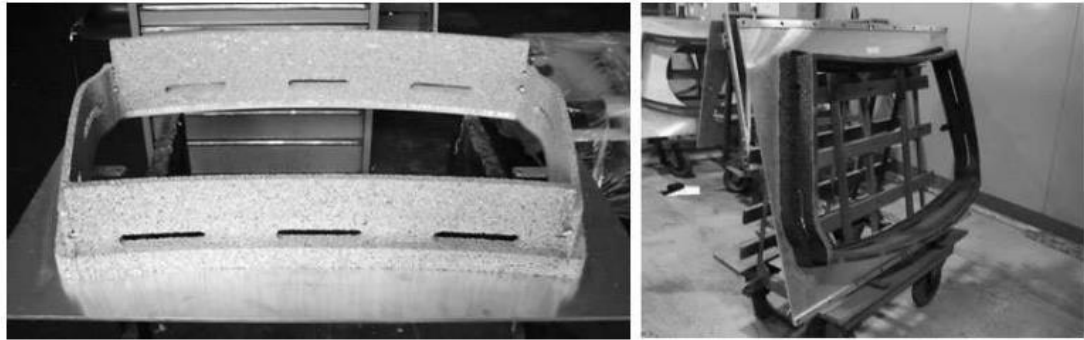
Figura 17: Ferramenta de levantamento de vidros com espuma de alumínio Alporas.
