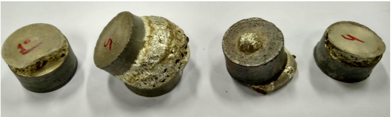
Figura 45: Corpos nº 1, 5, 6 e 4 do Lote C após sinterização a 710°C.
