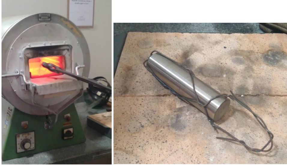
Figura 28: Forno Elétrico do Laboratório de Tratamentos Térmicos do CEFET-MG e eixo usinado preparado para o TT.
