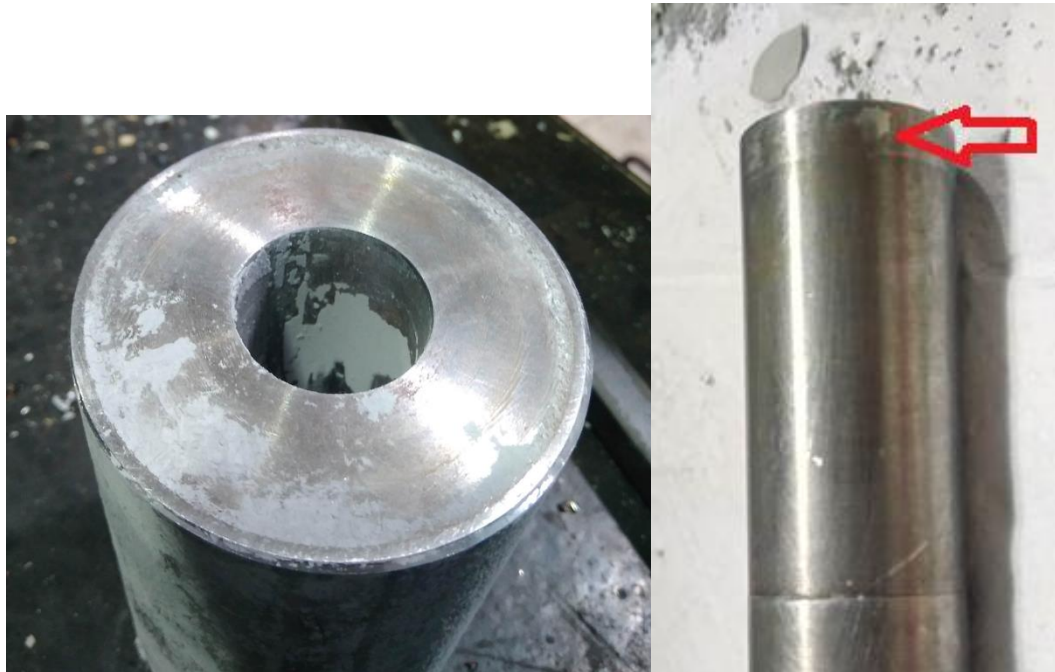
Figura 34: Adesão do pó de alumínio no molde, corpo (esq) e eixo (dir).
