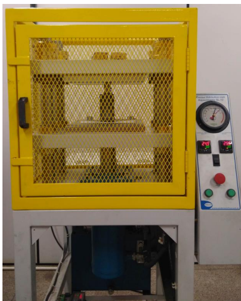
Figura 31: Prensa Hidráulica SL-12/20 com capacidade máxima de 20 toneladas.
