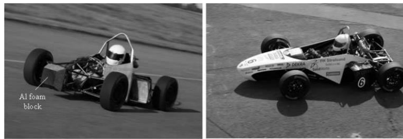
Figura 18: Protetor automobilístico de impacto de espuma de alumínio construído na Universidade de Tecnologia de Stralsund, Alemanha.
