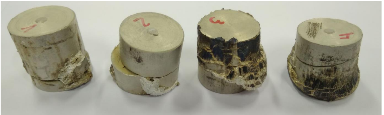
Figura 44: Corpos nº 1, 2, 3 e 4 do Lote B após sinterização a 710°C.
